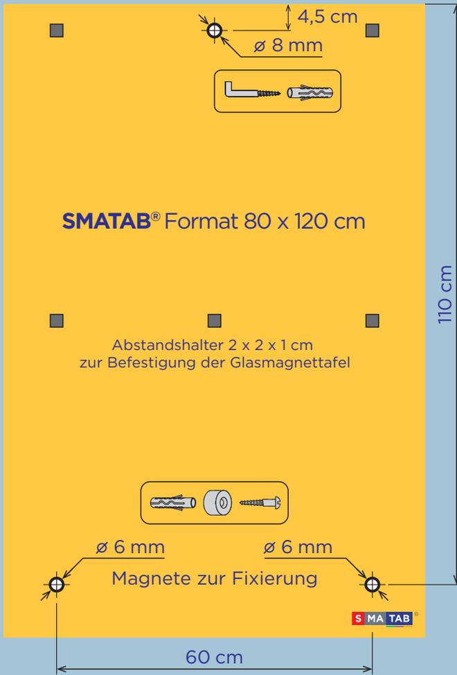
Bohren Sie das Dübelloch 4,5 cm unter der geplanten Oberkante der Platte.
